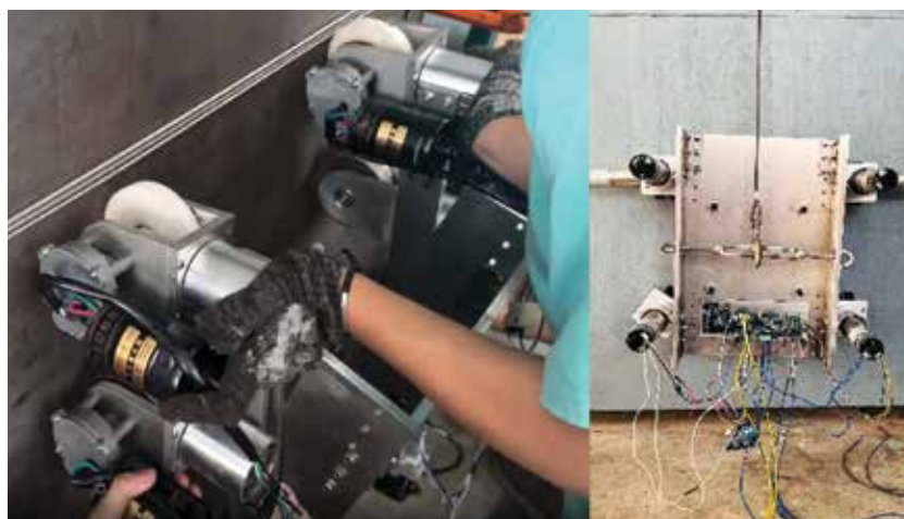
Hình 2. Thí nghiệm robot di chuyển trên thành bồn đứng, vượt qua đường hàn.
