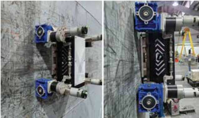
Hình 11. Robot đang thử nghiệm trên tấm thép đứng tại xưởng.
