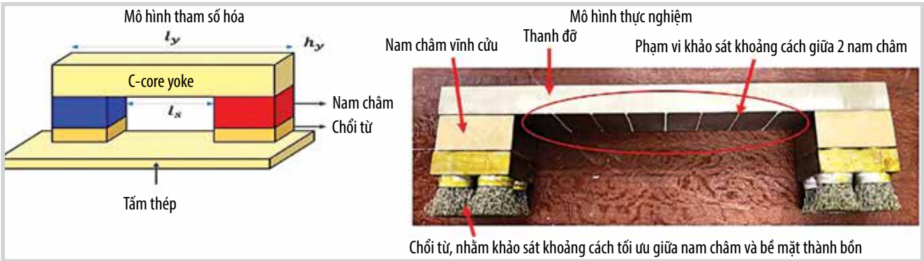
Hình 5. Mô hình tham số hóa và thực nghiệm trong thiết kế hệ từ hóa.
