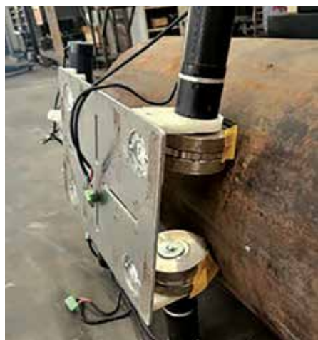
Hình 1. Thí nghiệm robot di chuyển trên bề mặt cong.
